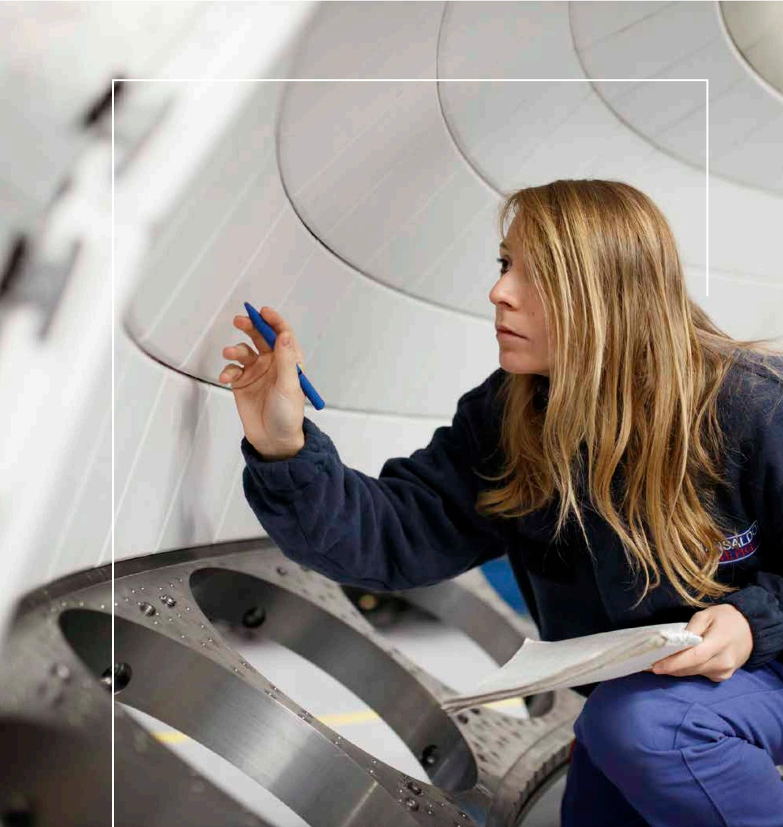
*Controllo delle piastrelle di una camera di combustione di turbina a gas*
