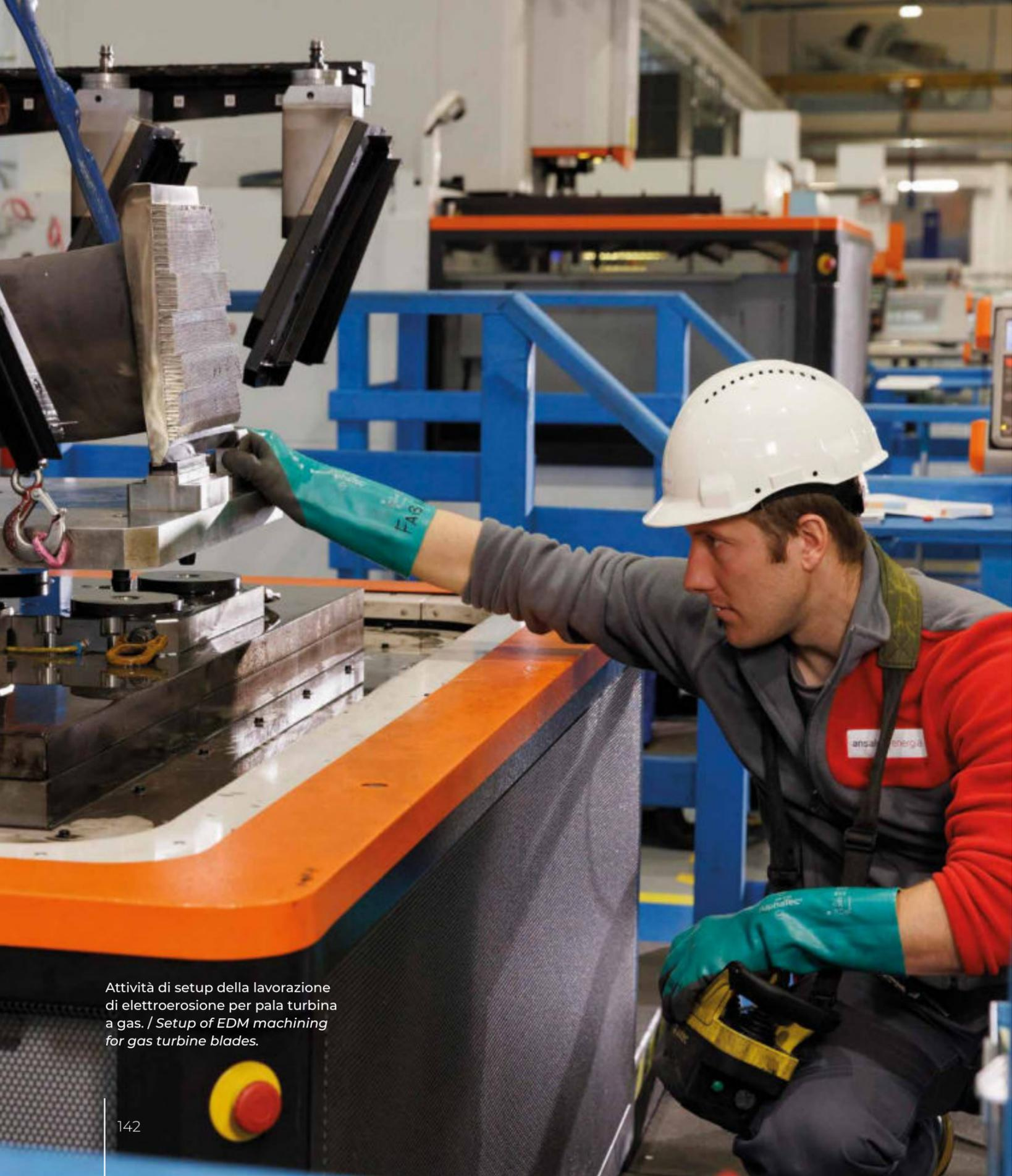
Attività di setup della lavorazione di elettroerosione per pala turbina a gas. / Setup of EDM machining for gas turbine blades.
